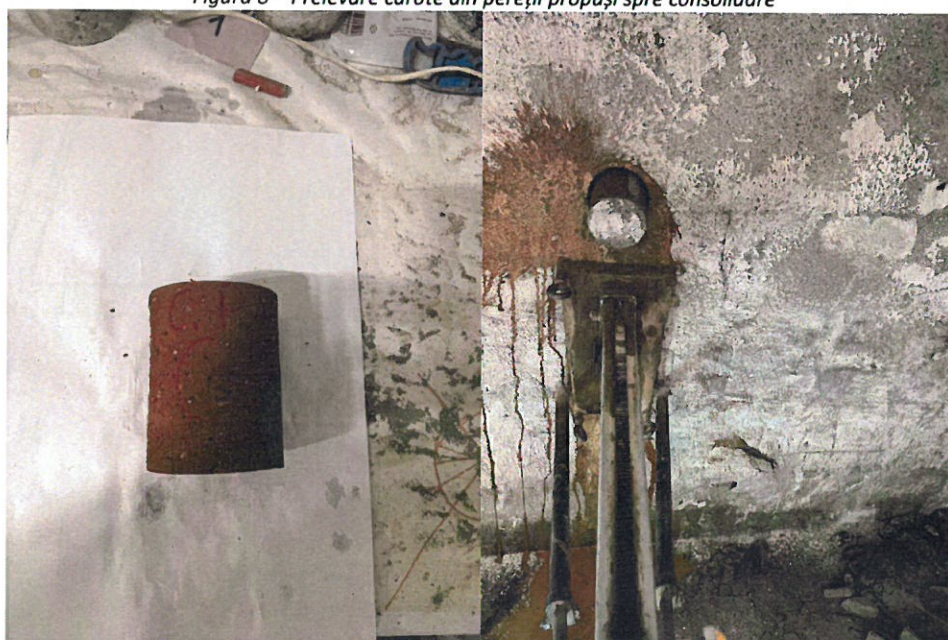
Figura 9 – Carote din zidărie, fără strat de cămășuială din beton sau torcret
